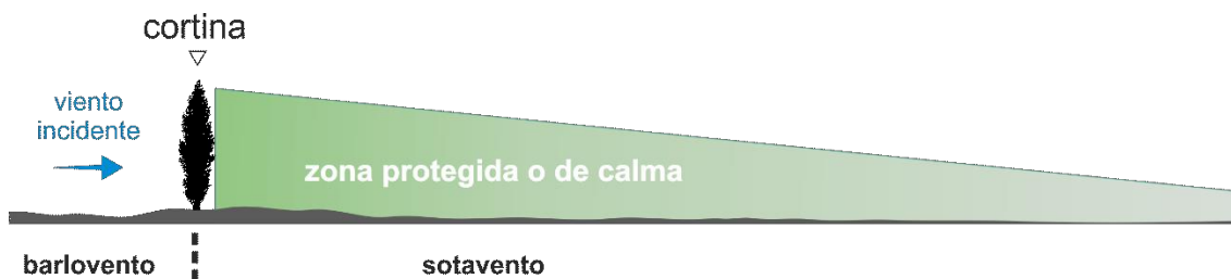
Figura 6. Esquema de perfil de una cortina y sus zonas de barlovento y sotavento.
