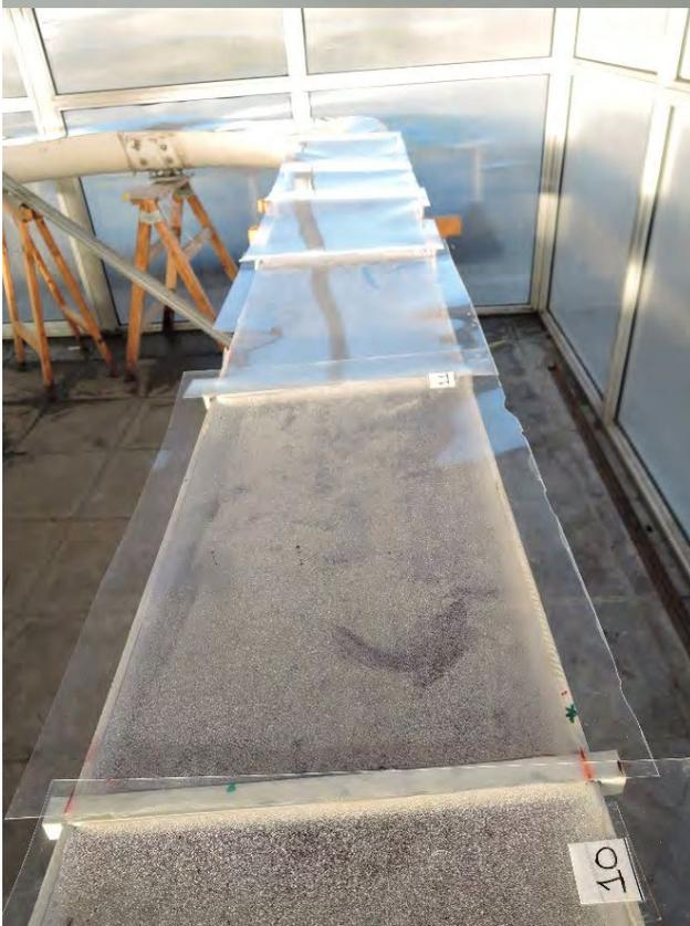
**Foto IV:** detalle del mesocosmos cubierto con placas de acetato para evitar la contaminación externa.
