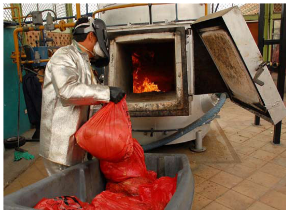
Figura 7. Aquí se muestra un horno incinerador y eliminación final de RPBI, así como vestimenta usada y medidas de bioseguridad por el trabajador de la empresa externa.
