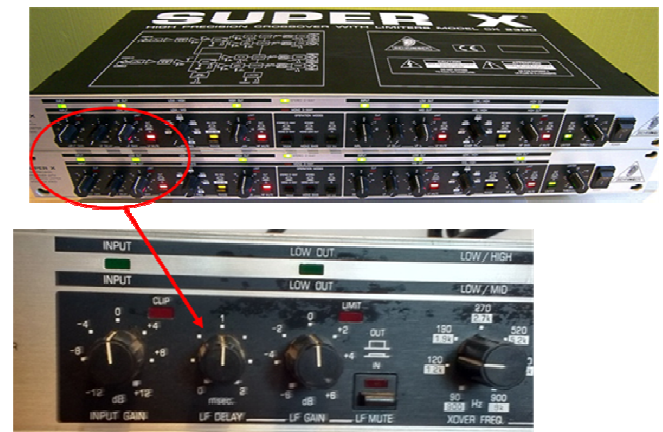
Fig. 3. Crossover analógico con su filtro pasa todo (LF delay) para retrasar las bajas frecuencias.
