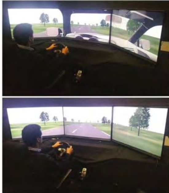
Figura 2.12: Configuración virtual del simulador con cabina y sin cabina. Fuente [17]
