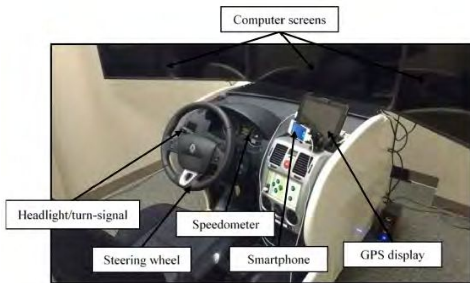
Figura 2.7: Simulador de conducción interactivo, desarrollado en Nextrans Center en la universidad Purdue. Fuente [12]
