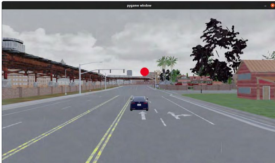
Figura 4.4: Simulador de conducción en un día lluvioso y se muestra el punto rojo correspondiente al DRT en pantalla
