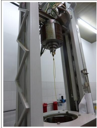
**Figura 2-6:** Vista de las conexiones de termocuplas Tipo K en el cabezal superior
