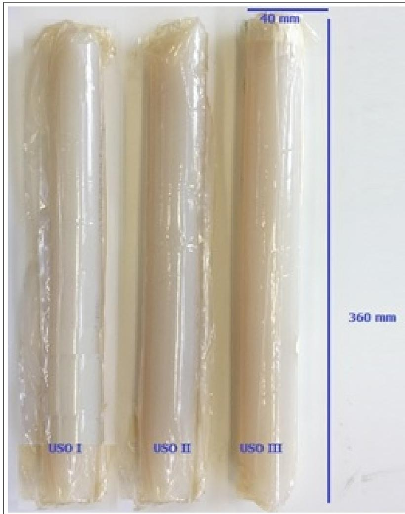
**Figura 2-37:** Cilindros de ágar nutritivo utilizados como carga de producto durante el procesamiento por APH
