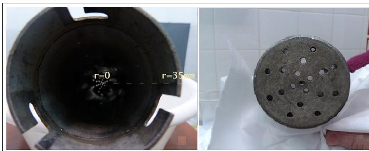
**Figura 3-8:** Vista de la posición radial de la canasta metálica utilizada en los ensayos experimentales
