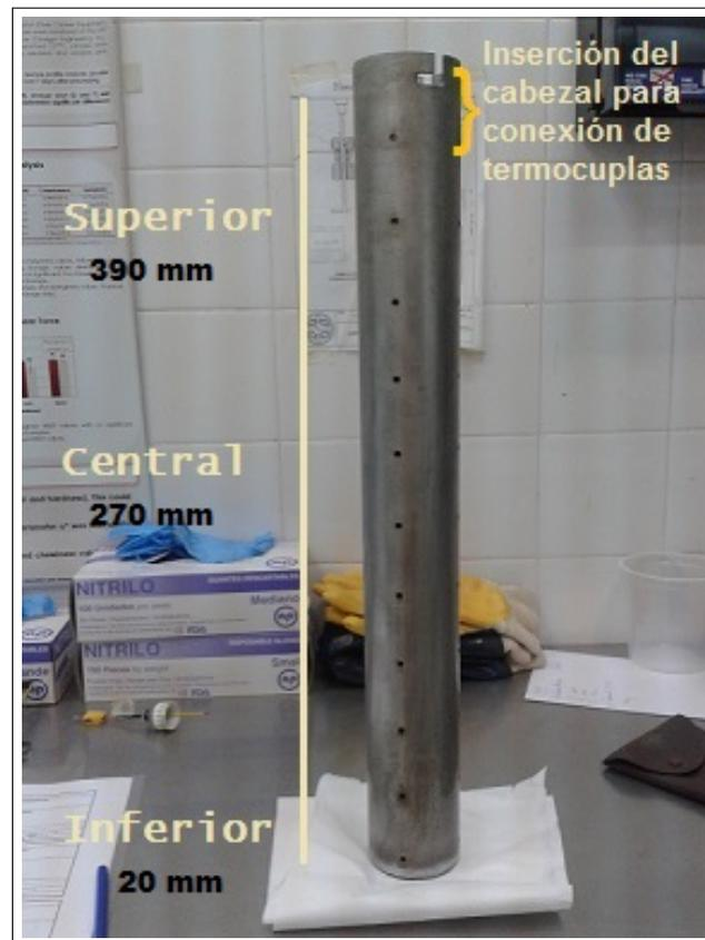
Figura 2-10: Posiciones axiales evaluadas en la canasta metálica
