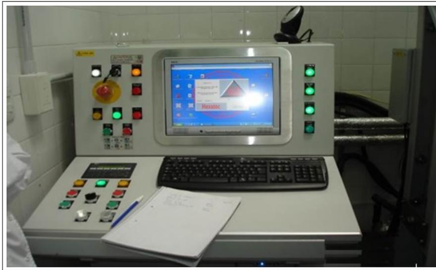
**Figura 2-5:** Módulo de control del equipo APH marca Stansted Fluid Power Ltd. modelo FPG9400:922
