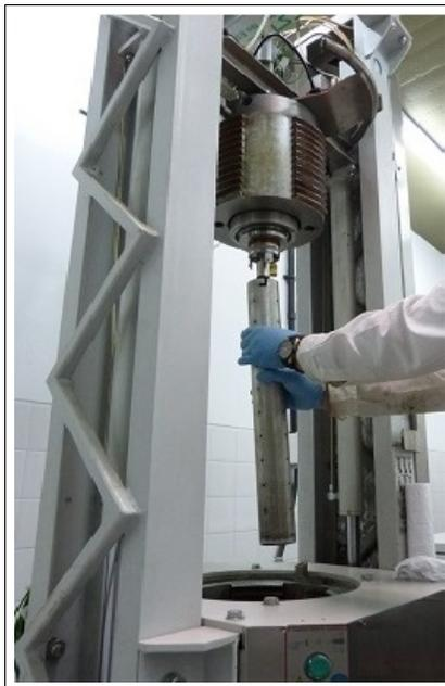
**Figura 2-7:** Conexión e ingreso de canasta metálica en el interior del equipo APH
