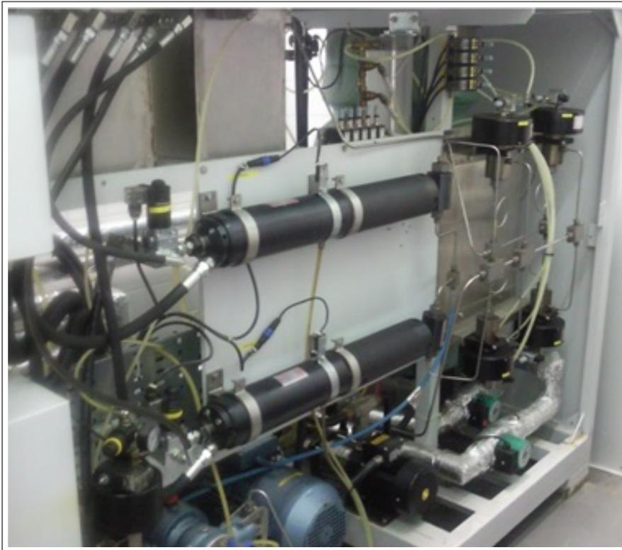
**Figura 2-3:** Módulo de servicio del equipo APH Stansted Fluid Power Ltd. modelo FPG9400:922
