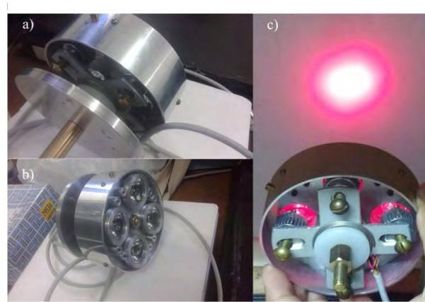
Figura 20. Diseño de L-660-12: a) fotografía del sistema II de la figura 19c; b) cuatro lentes móviles montadas en una plataforma; c) el sistema LED-disipador se apoya en tornillos que atraviesan otra plataforma.
