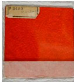
Figura 86. Filtro rojo escalón que transmite a partir de 600 nm.
