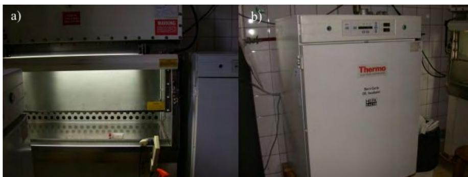
Figura 10. Equipamiento en el laboratorio: a) flujo laminar; b) estufa de cultivo celular a  $37^{\circ}\text{C}$ .
