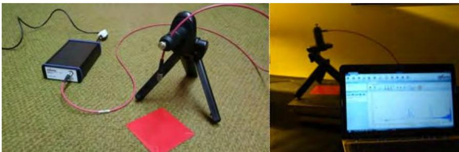
Figura 26. Espectrómetro AvaSpec-ULS3648-USB2-UA-25: a) entrada SMA 905, detector CCD de 3648 píxeles, rendija de 25  $\mu m$ , recubrimiento para UV DUV3648, filtro para reducción de efecto de segundo orden OSC-UA, conexión USB2, incluido; b) el cable de la fibra óptica FC-UVIR200-2, 200  $\mu m$ , longitud 2
