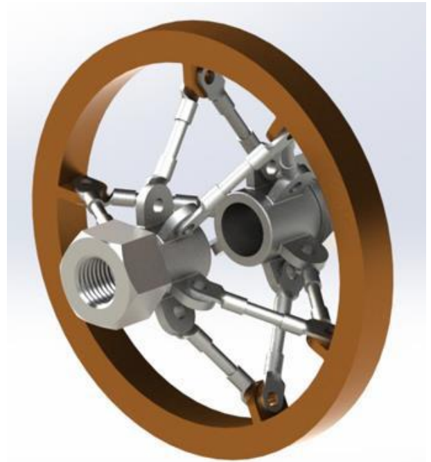
Figura 4. Prototipo virtual del sistema de respaldo de soldadura circunferencial.
