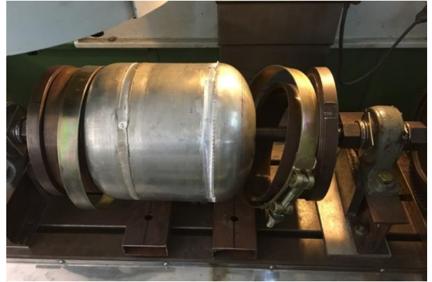
Figura 10. Elemento completo en el cual fueron realizadas ambas soldaduras circunferenciales.
