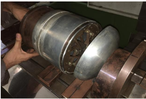
Figura 9. Armado del conjunto para unión del segundo casquete.
