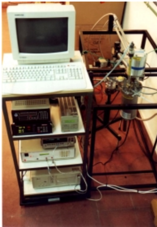
- Fig. 3 En esta fotografía, tomada desde un ángulo superior puede verse a la izquierda la PC que contiene la tarjeta GPIB y el rack con el equipo electrónico de medida y control. A la derecha se aprecia el cabezal expansor del criógeno. Detrás del mismo, en último plano se ve una parte de la bomba turbomolecular. -
