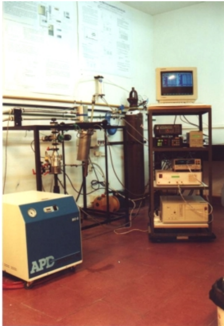
- Fig. 2 En la figura puede verse el sistema completo. Abajo a la izquierda está el compresor APD. En el centro se puede apreciar la bomba de vacío y la cabeza del expansor. A la derecha se ve el rack que contiene el instrumental electrónico y la Computadora Personal (PC). Al fondo se destaca el cilindro de He y su izquierda (en el piso) la bomba mecánica de 2 etapas. –
