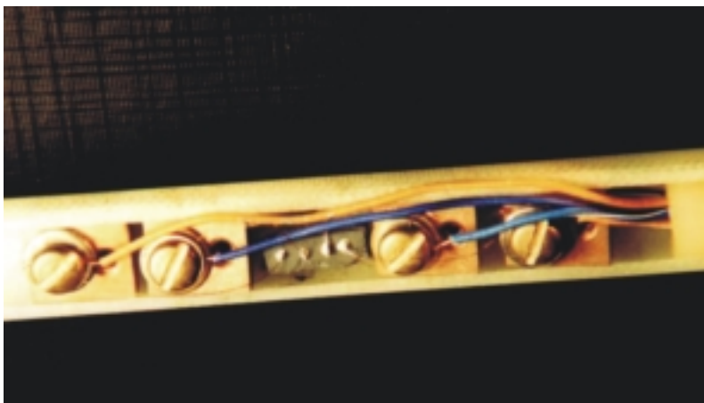
(d) Aquí puede verse un detalle del portamuestras con una muestra lista para ser medida.
