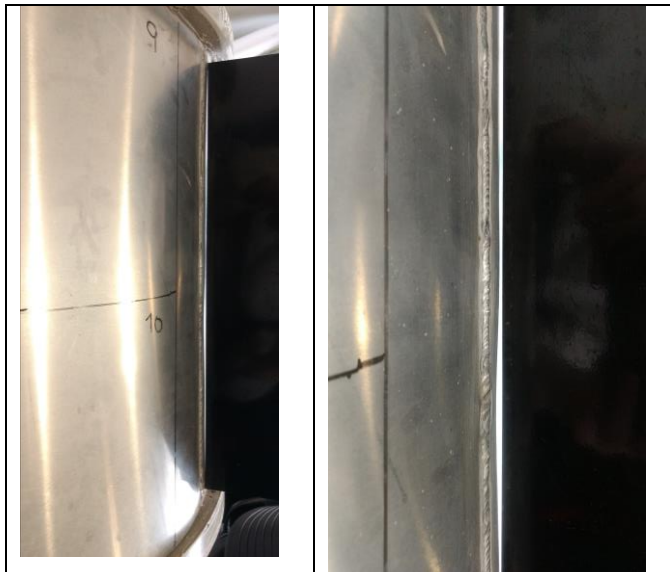
Figura 9: Deformación observada en un cilindro soldado.
