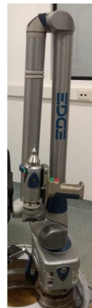
Figura 18: Brazo Faro utilizado.
