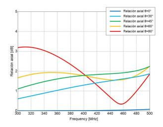
Figura 8. Relación axial en función de la frecuencia para valores del ángulo Theta.
