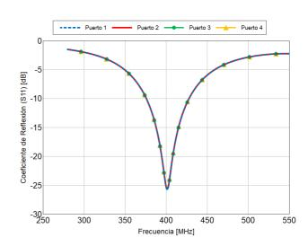
Figura 9. Adaptación de los puertos de la antena.
