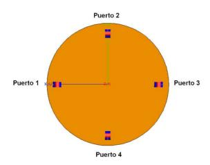
Figura 3. Puertos de alimentación de la antena.
