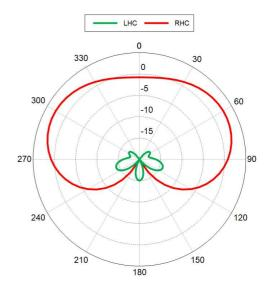
Figura 5. Diagrama de radiación simulado con discriminación de polarización.
