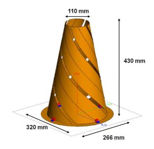
Figura 2. Antena Hélice Cuadrifilar Cónica.
