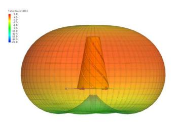
Figura 4. Diagrama de radiación 3D simulado.
