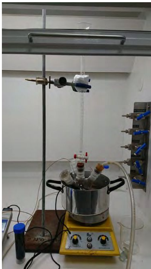
Figura 3.2: Montaje experimental para la elaboración de la síntesis de coprecipitación química
