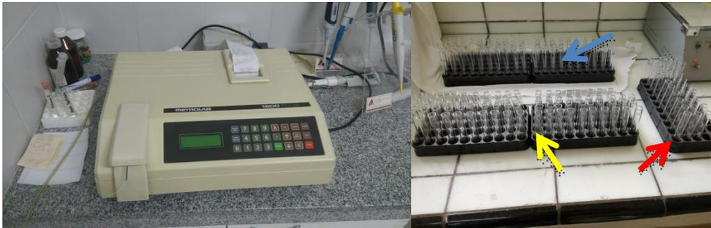
Figura 2.4. Espectrofotómetro (Metrolab 1600). Instrumento usado en el análisis químico para medir la cuantificación de sustancias (colesterol- flecha amarilla, triacilglicéridos- fecha azul y proteínas- flecha roja).
