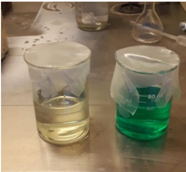
**Figura 4.** Soluciones utilizadas de ZnO sin dopar (traslúcido) y ZnO:Ni (verde).
