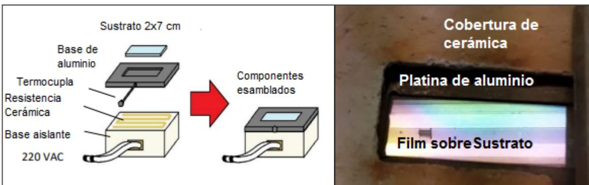
**Figura 3.** Componentes térmicos del dispositivo. Dispositivo térmico (izq.). Sustrato dentro de la base de aluminio con una cerámica de cobertura como aislante térmico (der.).
