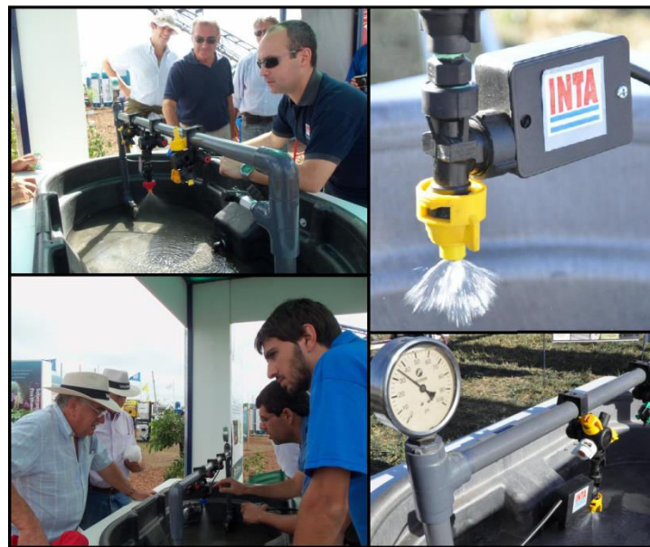
Fig. 4. Sistema de dosis variable PWM INTA
