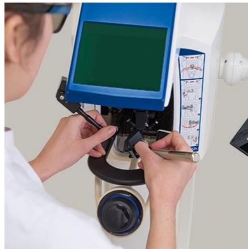
Ilustración 19, 20 y 21 - Simulador de realidad virtual 3D Simodont® que aplica tecnología háptica sofisticada utilizada en simuladores de aviación, adaptada y personalizada para la simulación dental. Fuente:
