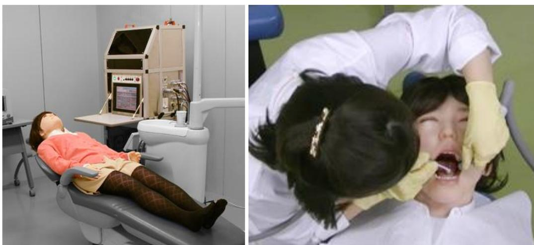
Ilustración 17 y 18 - Simulador interactivo de paciente robótico DENTAROID. Fuente: <http://www.nissin-dental.net/>
