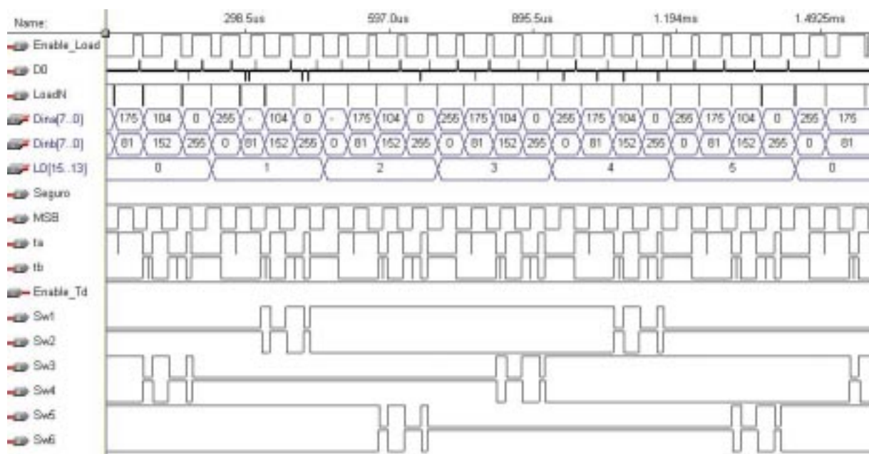
Figura 7.8: Resultados de simulación digital para el Modulador Vectorial Universal funcionando en el modo II de sobremodulación, con m = 0,98 y f = 681,576\text{Hz} (4 muestras por sector).
