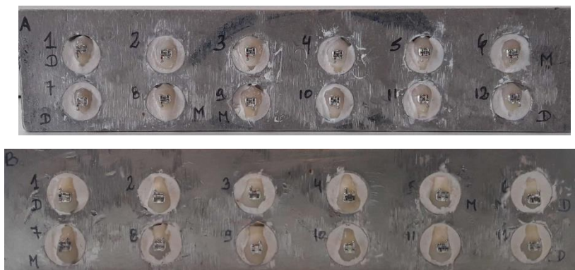
Figura N°45. Muestras del Grupo 1° preparadas para el ensayo de resistencia. Figura de la autora.
