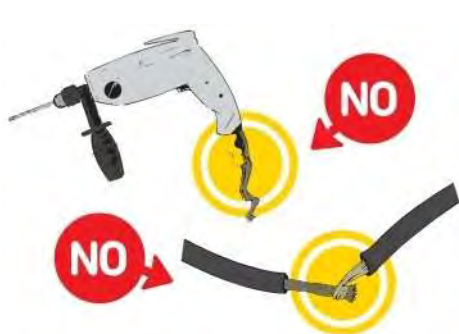
Gráfico N° II.35: Empalme indebido de cables en herramientas GRAFICO N° II.36: Uso de puesta a tierra.
