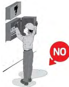
Gráfico N° II.39: Manipulación inadecuada de tableros eléctricos.
