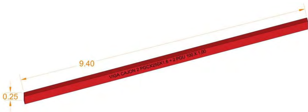
Gráfico N° II.16: Imagen de viga cajón
