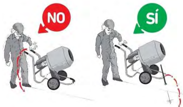
Gráfico N° II.35: Empalme indebido de cables en herramientas GRAFICO N° II.36: Uso de puesta a tierra.
