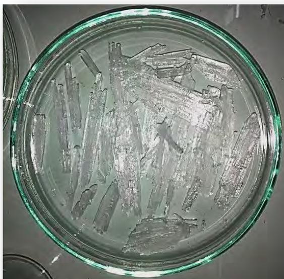
**Figura 5.1** Cristales del aducto  $\text{NH}_2\text{C}(\text{O})\text{NH}_2:\text{H}_2\text{O}_2$ .
