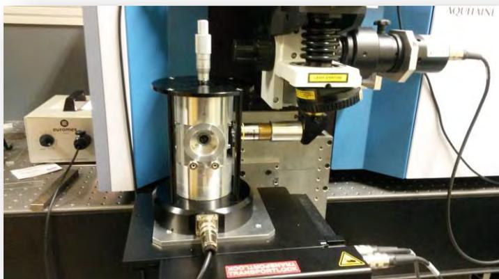
**Figura 2.14** Celda de levitación acústica acoplada al microespectrómetro Raman (Universidad de Bordeaux).
