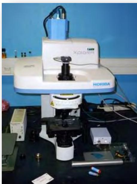
**Figura 8.19** Espectrómetro  $\mu$ -Raman XploRA, Horiba Jobin-Yvon.
