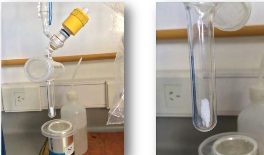
**Figura 5.2** Celda de 10 cm, con el cristal en su interior del aducto NH<sub>2</sub>C(O)NH<sub>2</sub>:H<sub>2</sub>O<sub>2</sub> en vacío.
