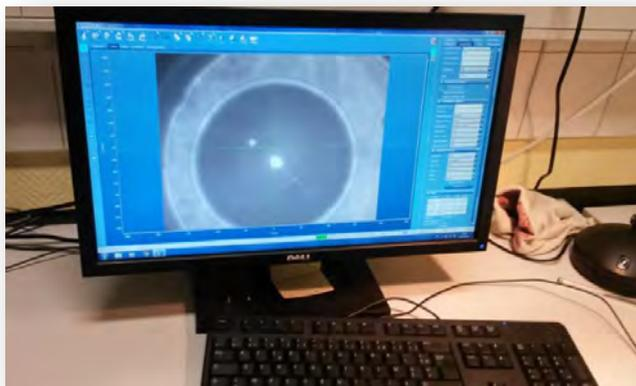
**Figura 8.17** Microgota del APS observada a través del microscopio ubicado en la celda de levitación.
