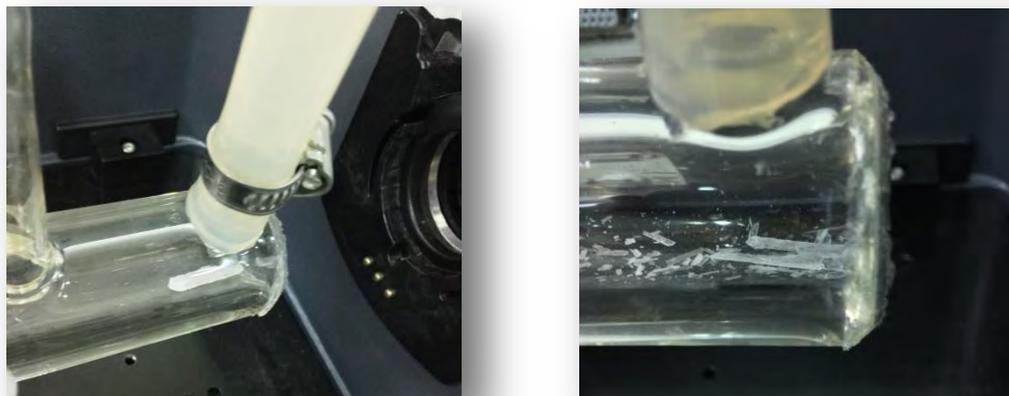
**Figura 5.4** Imagen el cristal del aducto  $\text{NH}_2\text{C}(\text{O})\text{NH}_2\cdot\text{H}_2\text{O}_2$  dentro de la celda termostatizable antes de ser calentado (figura de la izquierda) y después de ser calentado (figura de la derecha).
