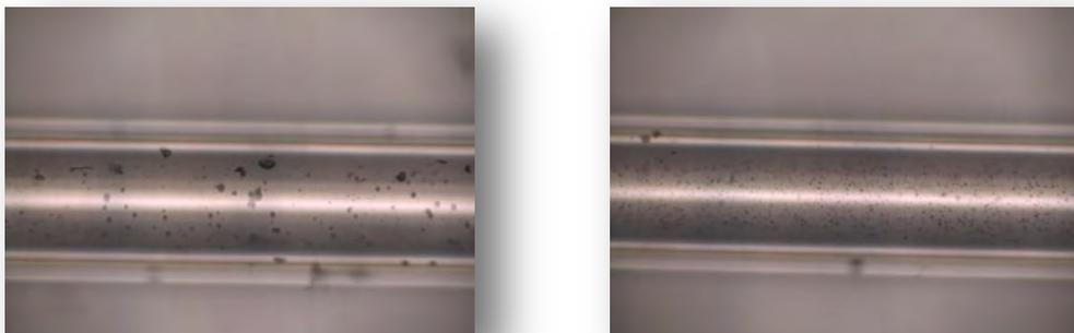
**Figura 8.21** Capilares de cuarzo conteniendo la muestra de APS con burbujas después de irradiar 5 (imagen izquierda) y 10 minutos (imagen derecha).
