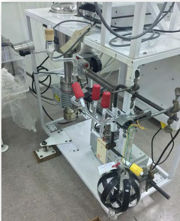
**Figura 7.1** Montaje para las experiencias en matriz entre el H<sub>2</sub>O<sub>2</sub> y los COVs.
