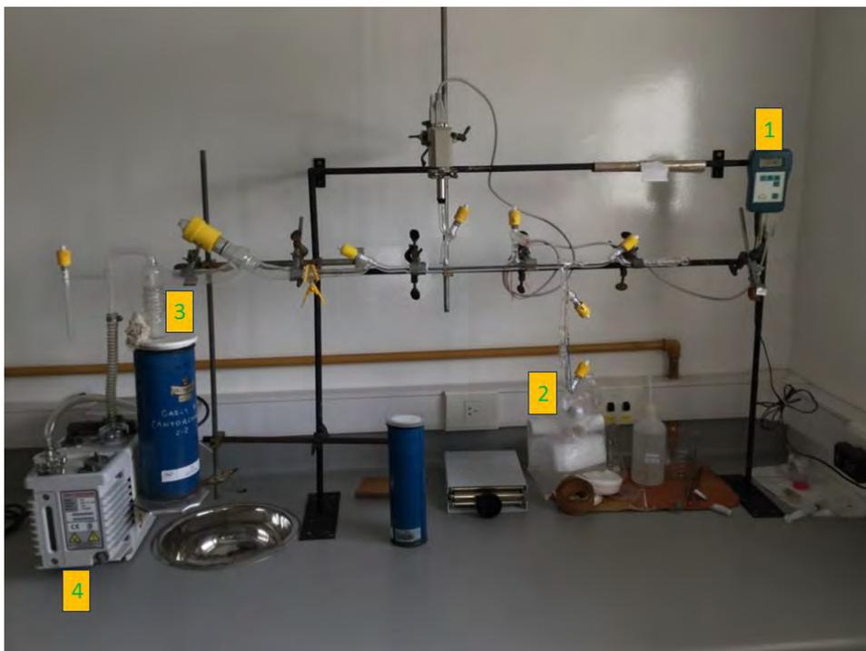
**Figura 2.1** Representación esquemática de una línea de vacío típica. (1) Manómetro marca ILMVAC; (2) celda para gases; (3) trampa para nitrógeno líquido; (4) bomba mecánica. (Foto sacada del laboratorio 20 del CEQUINOR.
