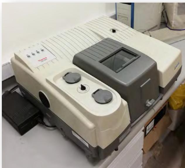
**Figura 2.4** Equipo espectrofotómetro Thermo–Nicolet modelo Nexus.
