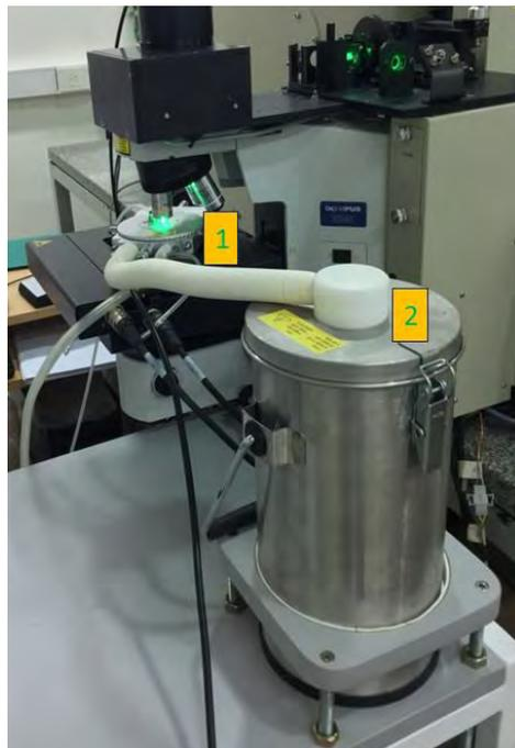
**Figura 2.6** Celda Linkam acoplada al espectrofotómetro Raman. (1) Celda Linkam, (2) termo para contener nitrógeno líquido (CEQUINOR).
