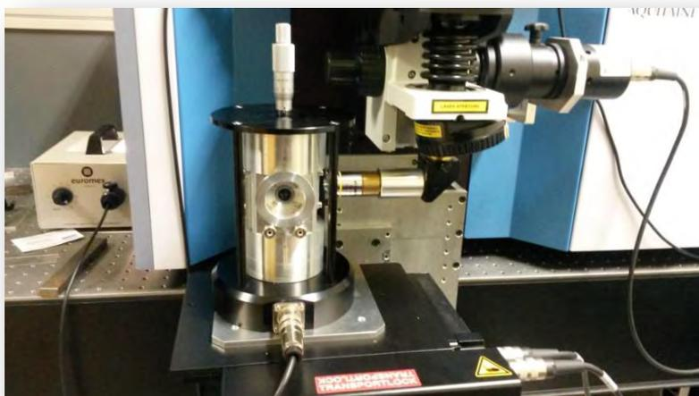
**Figura 8.18** Celda de levitación acústica acoplada al microespectrómetro Raman (Universidad de Bordeaux).
