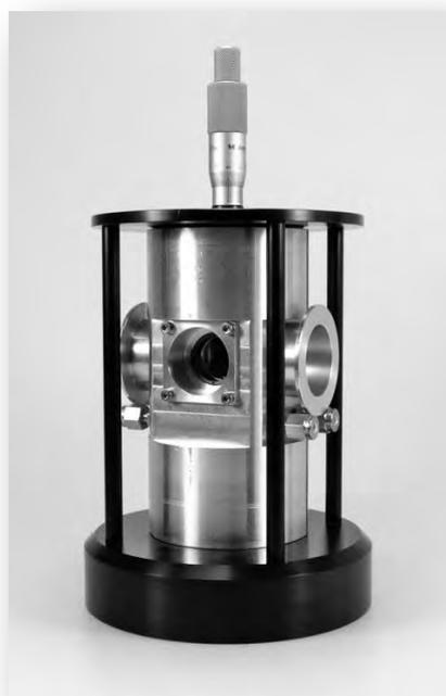
**Figura 2.13** Celda de levitación acústica (Universidad de Bordeaux).
