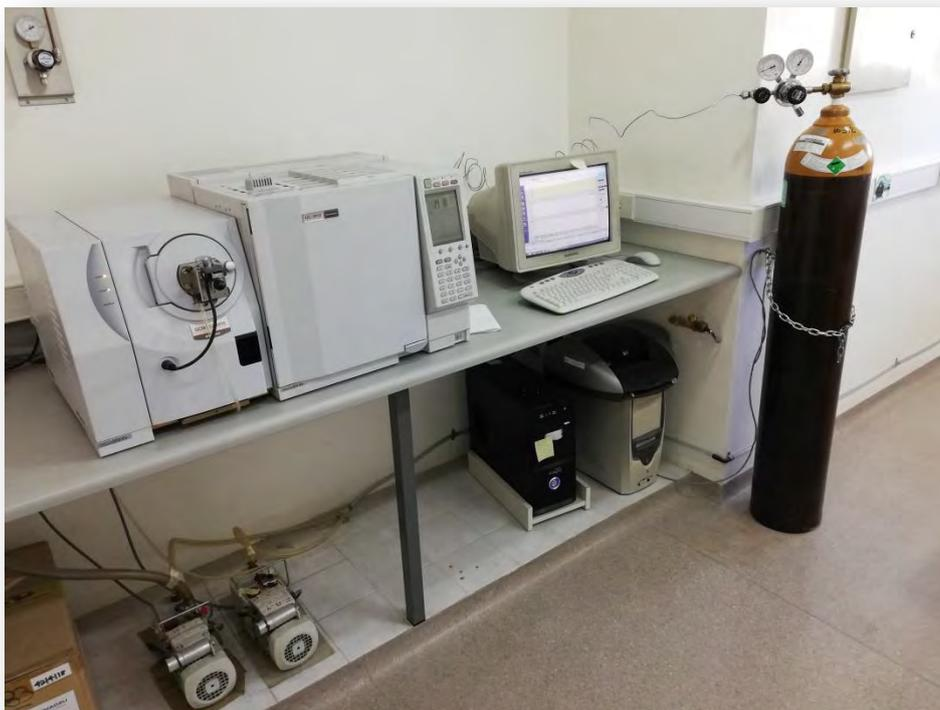
**Figura 2.11** Cromatógrafo de gases acoplado a un espectrómetro de masas (GCMS–QP2010).
