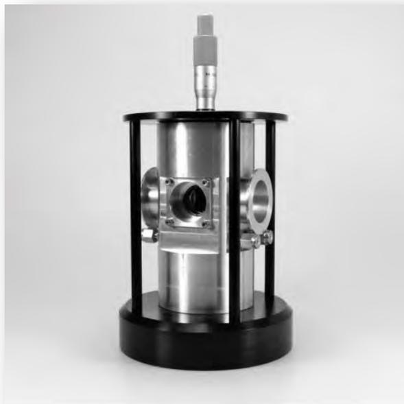
**Figura 8.15** Celda de levitación acústica (Universidad de Bordeaux).
