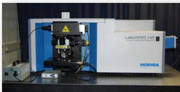
**Figura 8.16** Espectrómetro Raman Labram–HR Evolution, Horiba Jobin–Yvon.
