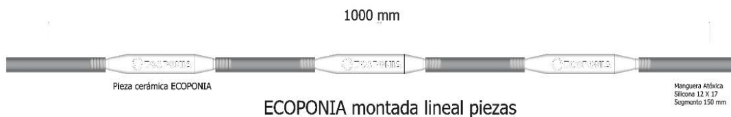
Figura. 2 modulación horizontal de piezas cerámicas por metro lineal, Adenda Técnica del fabricante. Benassi (2021).
