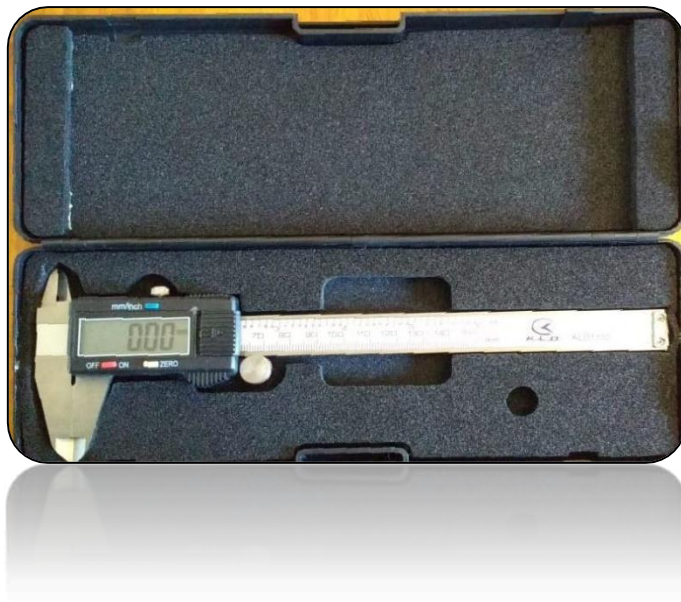
Fig. 6 Fotografía de Calibre Digital marca K.L.D. modelom1152 utilizado en la medición.
