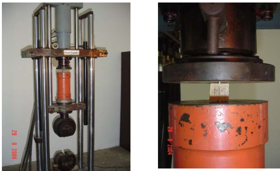
Figura 3.18: Ensayo de compresión diametral: Vista de la máquina y probeta utilizada
