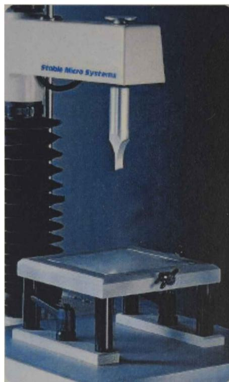
Figura A.5-1. Sonda Volodkevich empleada en los ensayos de punción sobre empanadas cocidas.
