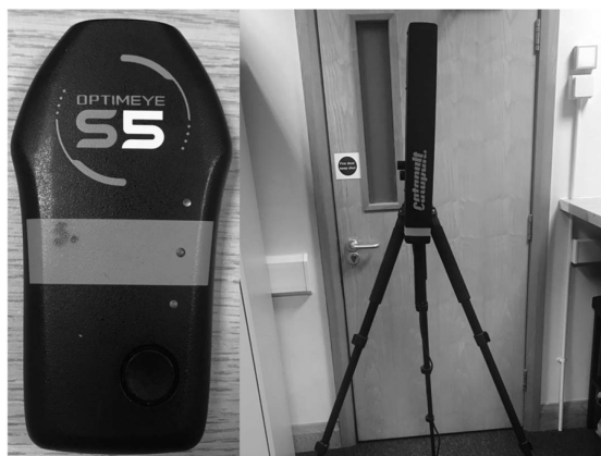
Figura 2. Imagen de una unidad de GPS(10 Hz.) con microtecnología integrada y la antena receptora para el uso en tiempo real(Weaving y cols., 2017).
