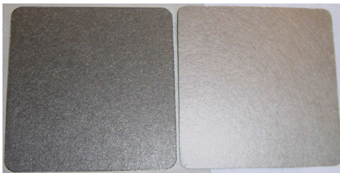
Fig. 2.3 Toray paper diffusion layers. IRI (CSIC-UPC)
