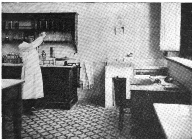
FIG. 7. — El trabajo de oficina del fiscalizador, después de la ordeñada de contralor (2) Llegado a su oficina, lo primero que debe hacer el fiscalizador es proceder a dosar la materia grasa en cada muestra de leche y anotar el resultado en cada frasco. El dosaje de la materia grasa es muy sencillo, elegante y exacto por el método de Gerber. Cualquiera persona prolija puede hacerlo, sin conocer química, y no requiere instalaciones costosas.
