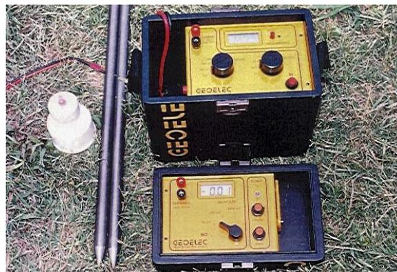
*Figura 21. Resistivímetro.*
