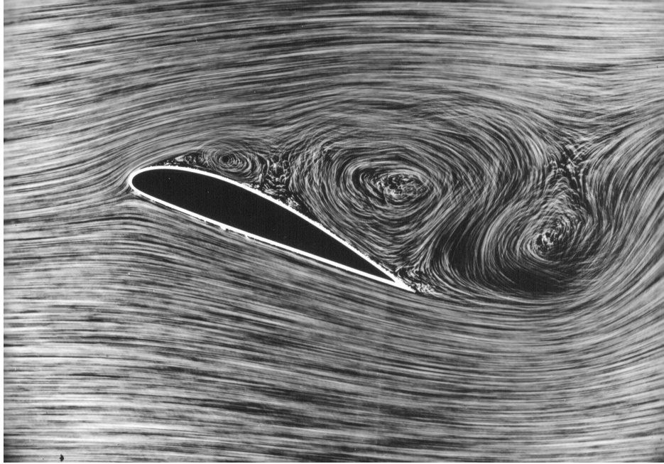
Figura 2.3: Entrada en pérdida de un perfil
