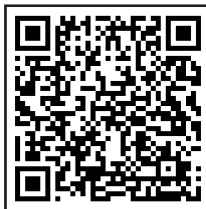
Figura 1. Código QR Modelo 2 Versión 5 compuesta por 37 x 37 módulos.
