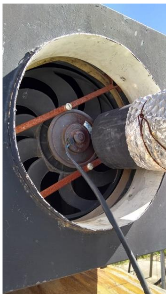
Figura 2 c. Entrada de aire recirculado
