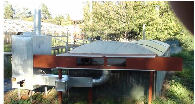
Figura 1. Esquema y vista del secadero tipo túnel
