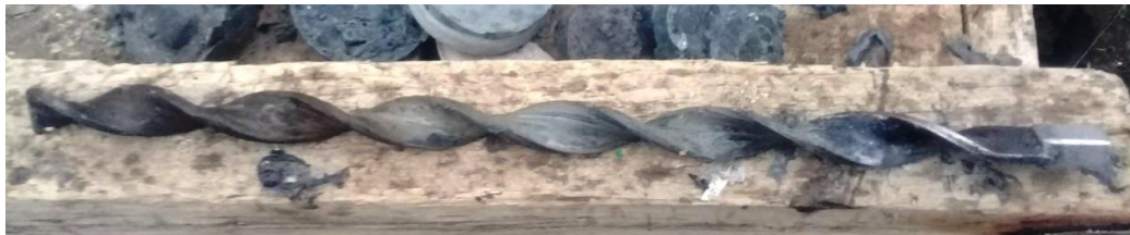
Figura 12- Hélice dentro de la extrusora.
