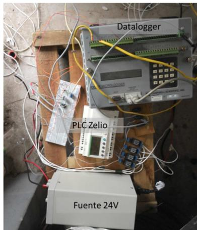
Figura 4 Sistema de automatización con PLC, fuente y adquisidor de datos.
