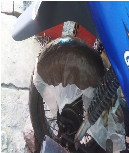
Fig.11. Fotografía de toma de impresión de arcilla negra entre nylon, de neumático trasero.
