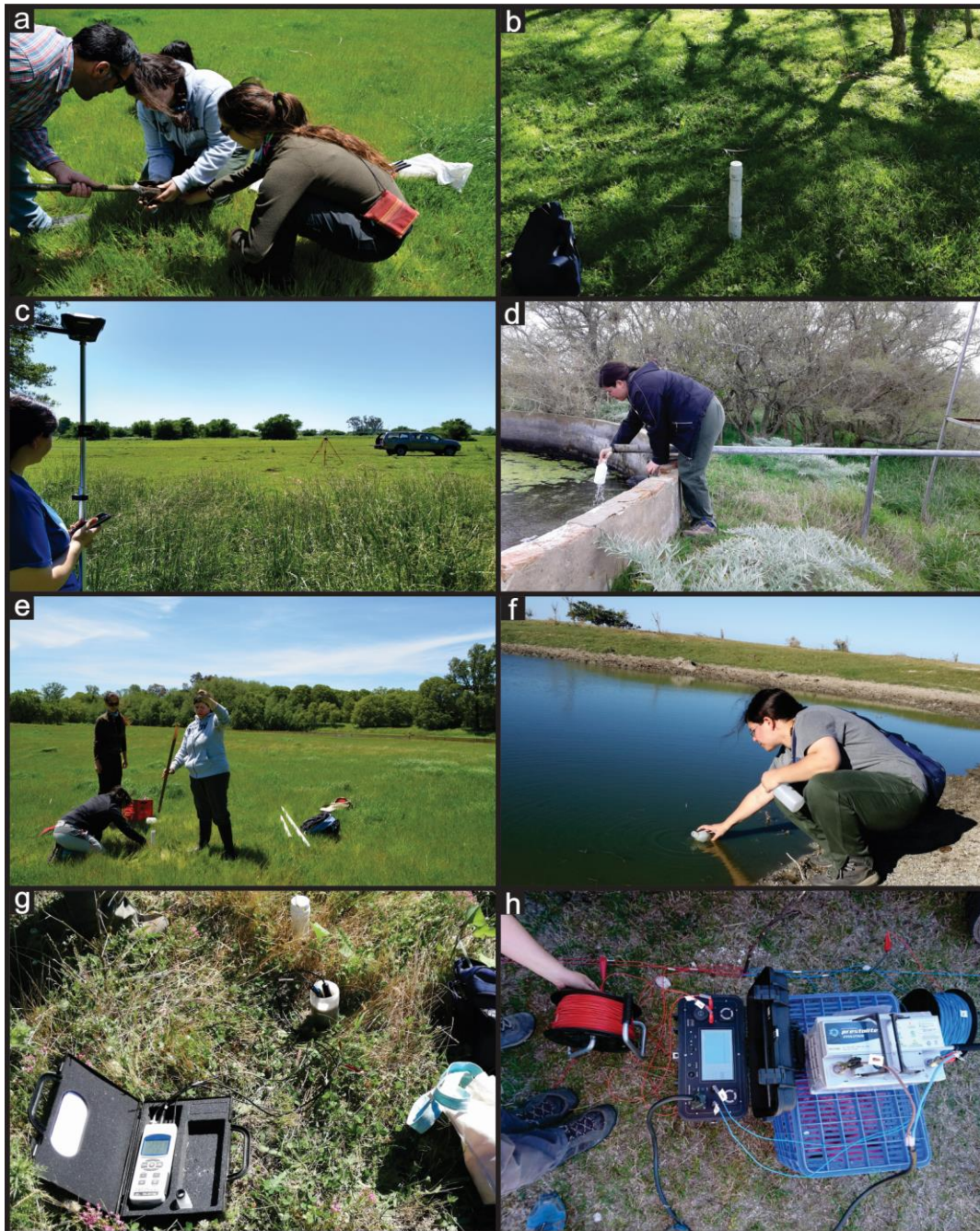
Figura II.2: Fotografías del trabajo de campo realizado: a. Construcción de los pozos de exploración someros mediante barreno con toma de sedimentos; b. Freatímetro; c. Nivelación de los puntos de muestreo por medio de GPS diferencial; d. Toma de muestra de agua subterránea en un molino; e. Toma de muestra de agua subterránea en un pozo de exploración somero; f. Toma de muestra de agua superficial en una cantera abandonada; g. Medición de parámetros fisicoquímicos in situ mediante equipo manual multiparamétrico; h. Equipo de geoelectricidad para la realización de los sondeos eléctricos verticales (SEVs).
