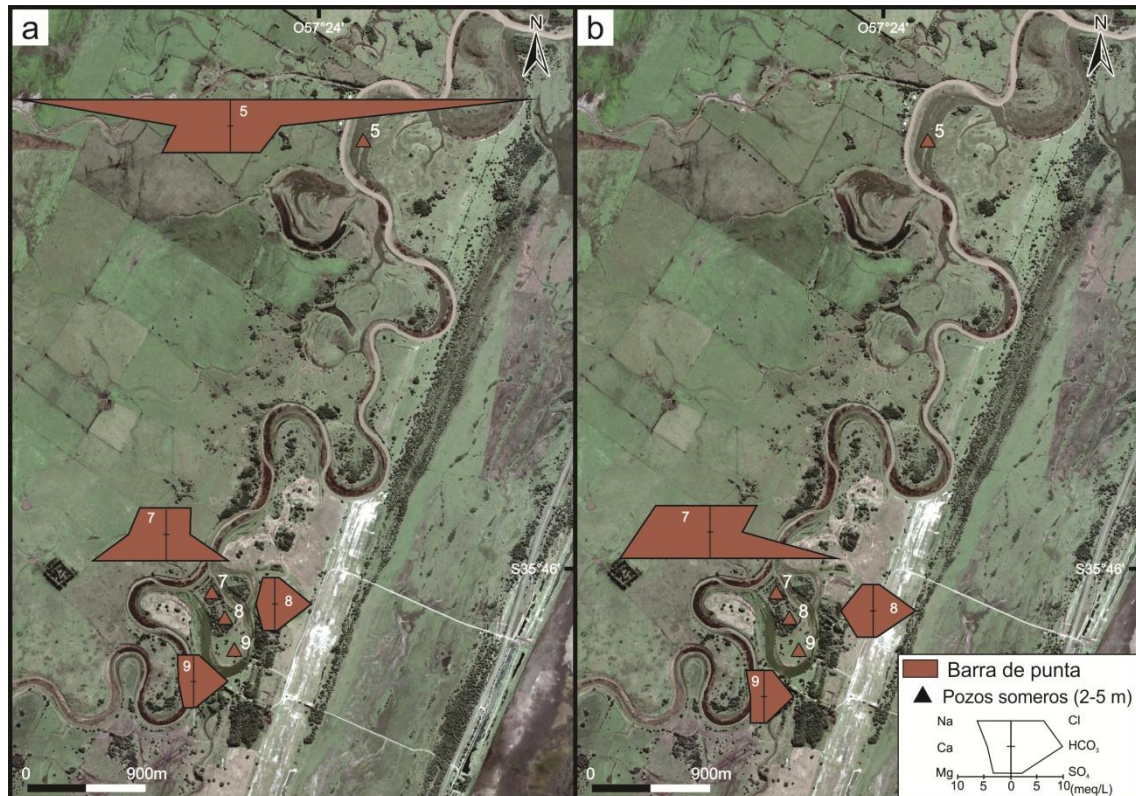
Figura VI.5: Variación espacial representada mediante diagramas de Stiff para el agua subterránea en las barras de punta. a. Muestreo noviembre 2017 (periodo de excesos hídricos); b. Muestreo marzo 2018 (periodo de déficit hídrico).
