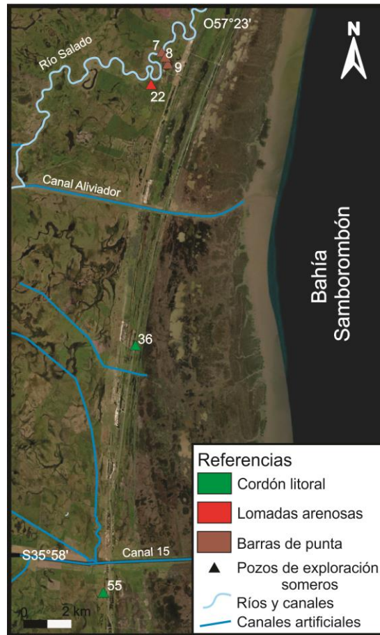
Figura V.5: Ubicación de los pozos de exploración someros donde se midieron niveles freáticos por medio de sonda manual y sensores de medición continua.
