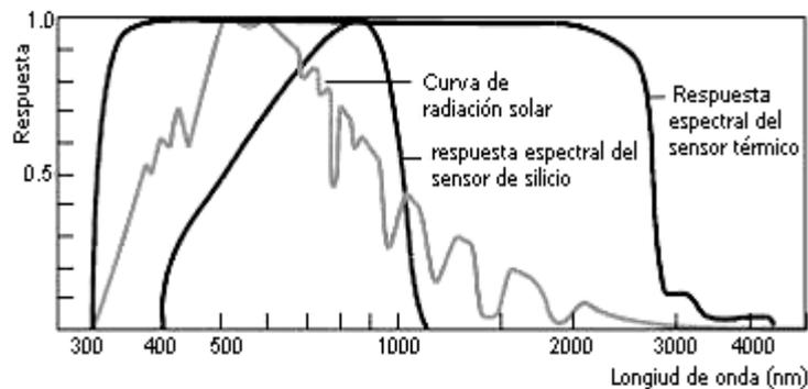
Figura 1: Curvas normalizadas mostrando la respuesta espectral de un sensor de silicio, un sensor térmico y el espectro solar a nivel del mar (Kipp & Zonen, 2005).
