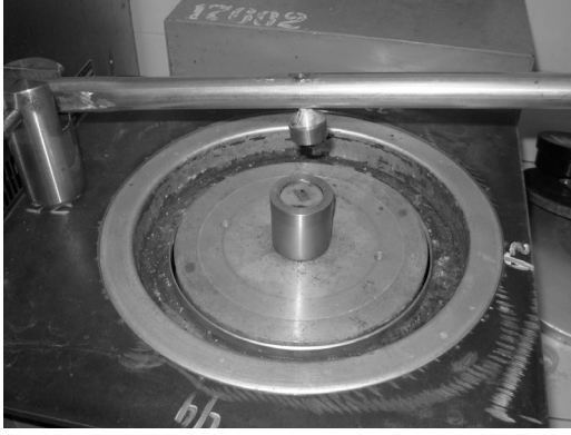
Fig.3 Brazo sobre los especímenes montados en los cilindros correspondientes Desplazamiento del plato móvil.
