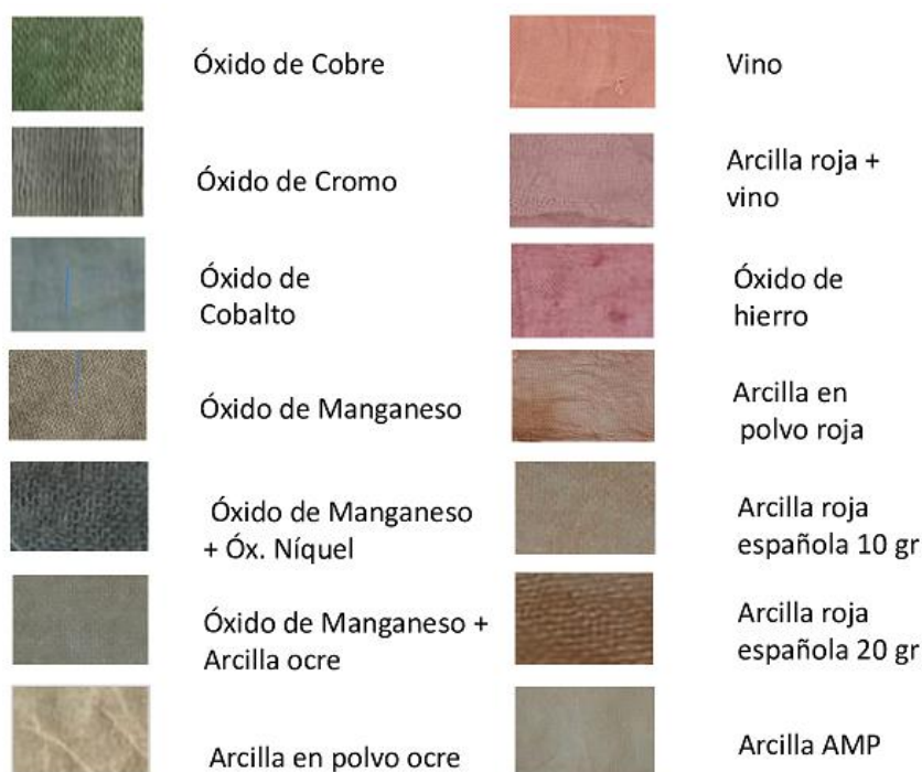
Figura 1. Registro de proceso. Tinturas con materiales cerámicos sobre gasa
