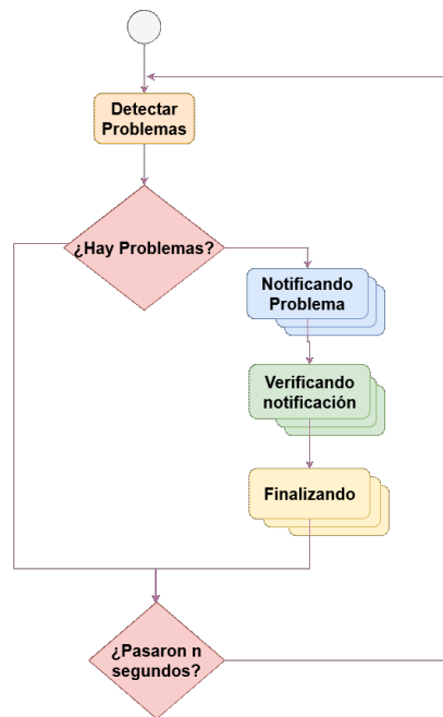
Figura 2. Funcionamiento del Agente Monitor
