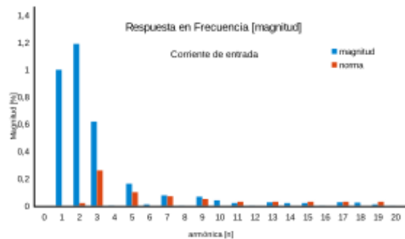
Figura 7: Descomposición en frecuencia de la corriente de entrada
