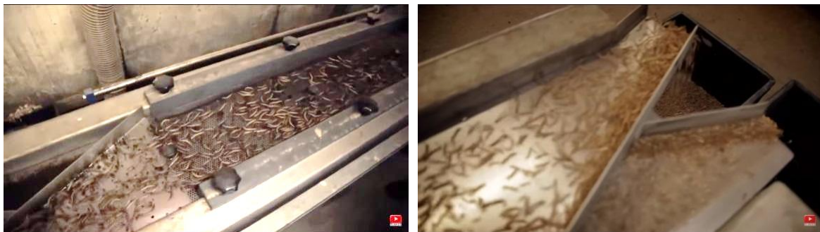
Figura 5. Cinta transportadora-tamizadora para separación de larvas de su sustrato (Protifarm, Países Bajos).
