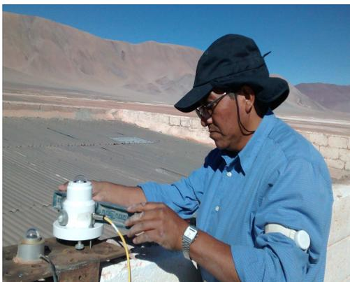
Fig 1: Radiómetros y dosímetro digital utilizado en el brazo para medir radiación UVER.
