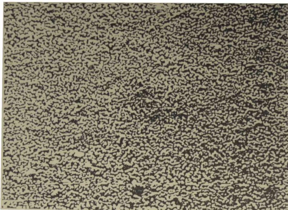
**Fig. 16:** Microfotografía correspondiente a un electrodo de Ag luego de anodizarlo en una solución 0,09 M de NaCl en un potencial  $E=0,07$  V durante 60min (3200X).
