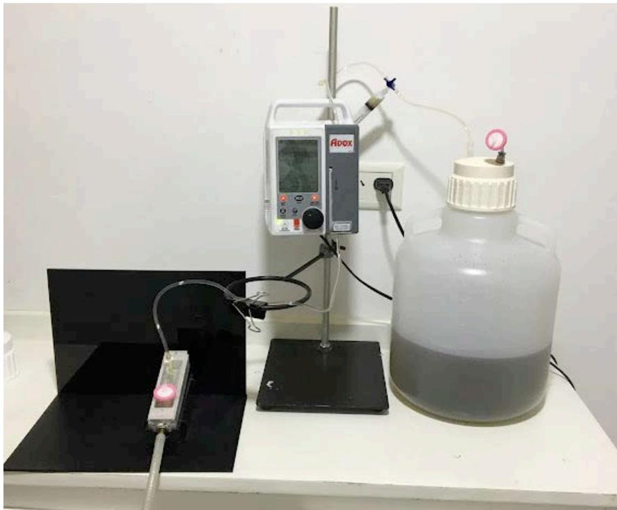
**Figura 4-B:** Sistema conectado incluyéndose el reactor por goteo utilizado para la formación de *biofilms* sobre portaobjetos, la bomba de alimentación y el tanque con el medio de cultivo.
