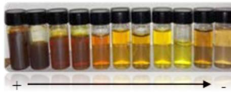
**Figura 8:** Nanopartículas de plata de diferentes tamaños y grados de agregación. Su tamaño decrece de izquierda a derecha. Los coloides se sintetizaron en el laboratorio.
