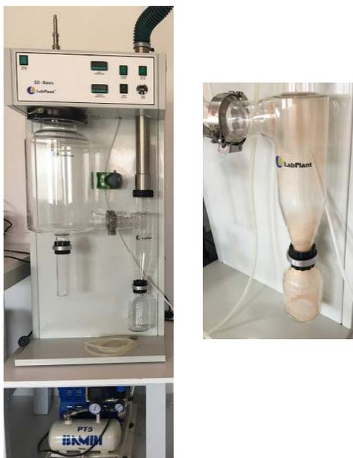
**Figura 4:** Secador por spray Lab Plant (SD-Basic) utilizado para secar las partículas.
