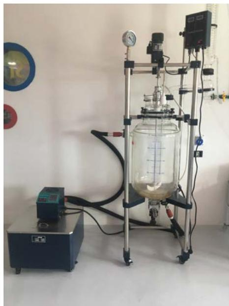
**Figura 4:** Reactor de vidrio de capacidad 50 L.
