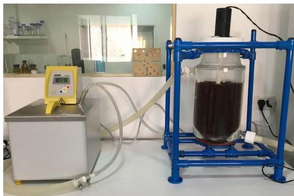
**Figura 2:** Sistema utilizado para realizar síntesis de las partículas *Core Shell*, siendo la capacidad máxima del reactor de 4 L.
