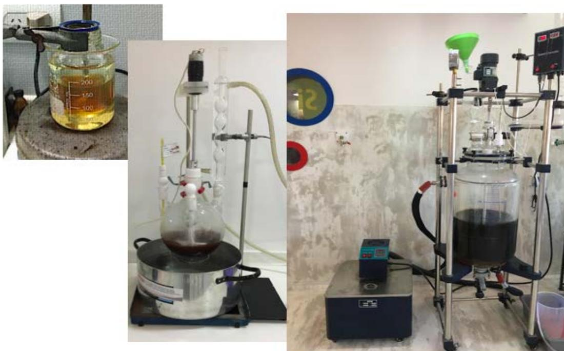
**Figura 14:** NpsAg obtenidas de la síntesis nombrada como síntesis 2, a diferentes escalas: 0,25 L, 3 L y 25 L.
