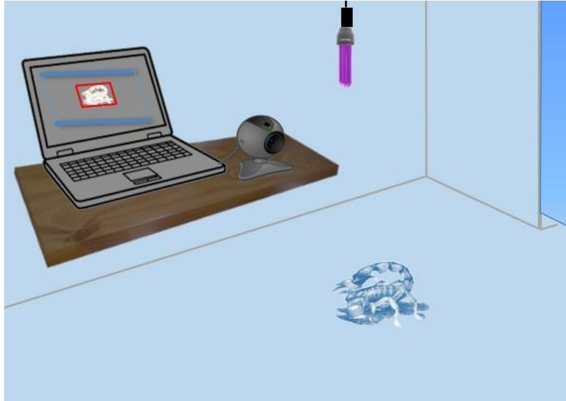
Fig. 52 Representación de sistema de detección de escorpiones por su fluorescencia
