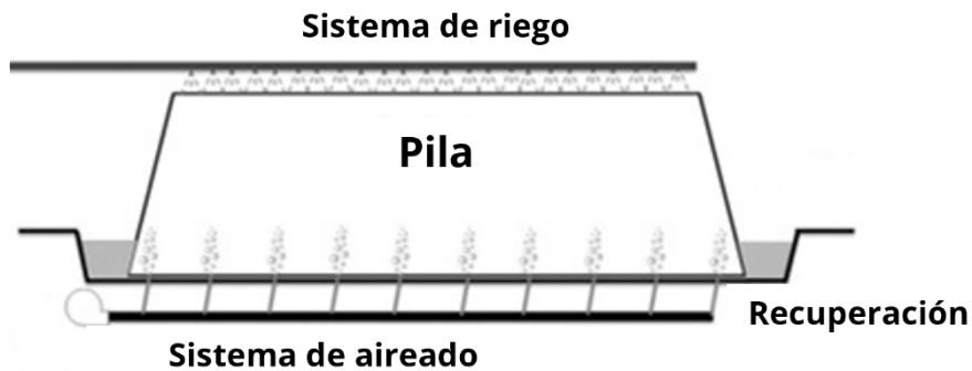
Figura 1.5 – Esquema de una pila de biolixiviación. (Figura modificada de Petersen (2016)).
