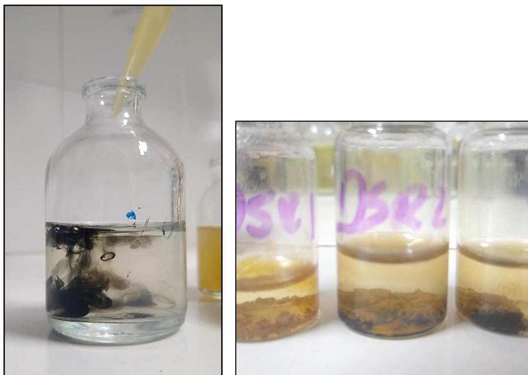
Figura 4.24 – Formación de compuestos insolubles al agregar muestra de DAM a una solución de cultivo sulfato-reductor. A la izquierda, aparición instantánea de compuestos color negro; a la derecha, depósitos ocre-anaranjados formados tras 24 h de incubación a 25°C sin agitación.
