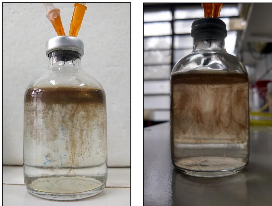
Figura 4.32 – Compuestos insolubles formados durante la experiencia del Sistema D y E. Puede observarse una mayor cantidad de partículas, con relación al Sistema C, y la acumulación en la interfase.
