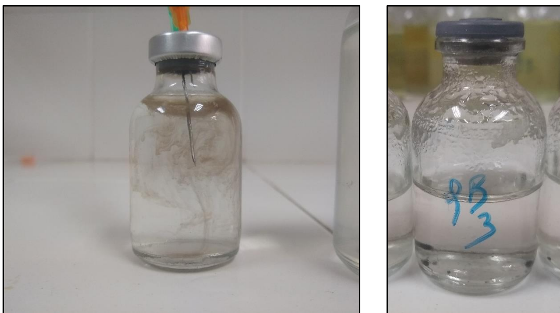
Figura 4.33 – Formación de compuestos insolubles tras la transferencia de H_2S(g) desde el cultivo microbiano. A la izquierda la formación durante los primeros minutos de transferencia, con acumulación en la interfase líquido-gas; a la derecha, los compuestos decantados luego de 24 h.
