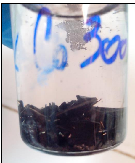
Figura 4.18 – Compuestos insolubles de color negro metálico formados tras agregar una solución de cobalto (300 mg/L concentración final) al cultivo desarrollado del consorcio sulfato-reductor SAnCo.
