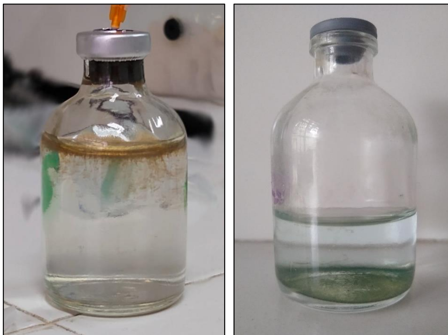
Figura 4.31 – Compuestos insolubles formados en el Sistema C. A la izquierda, compuestos color marrón formados en la interfase líquido-gas que decantan hacia el fondo del vial. A la derecha, sedimentos color azul-verdoso tras días de maduración a temperatura ambiente.
