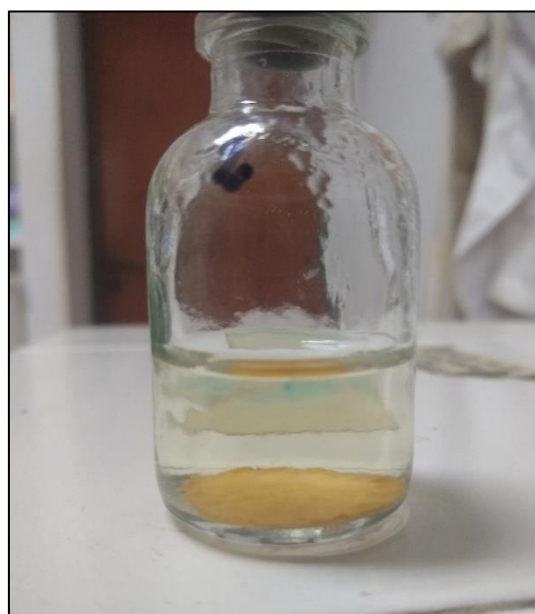
Figura 4.25 – Compuestos insolubles formados tras 24 h de mezclar una muestra de DAM con un cultivo sulfato-reductor en una relación 3 a 1.
