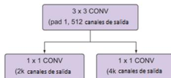
**Figura 4.10: Implementación convolucional de una arquitectura RPN, donde k es el número de anclas (anchors).**
