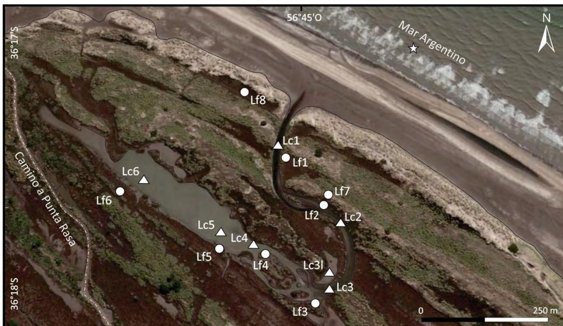
**Figura 2.8.** Red de monitoreo del Sector Norte. Los círculos representan los puntos de extracción de agua subterránea, correspondientes a freáticos someros. Los triángulos representan los puntos de extracción de agua superficial.
