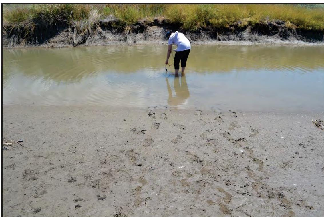
**Figura 2.9.** Foto tomada en campo durante la medición *in situ* de parámetros fisicoquímicos como pH y conductividad eléctrica en el agua superficial.
