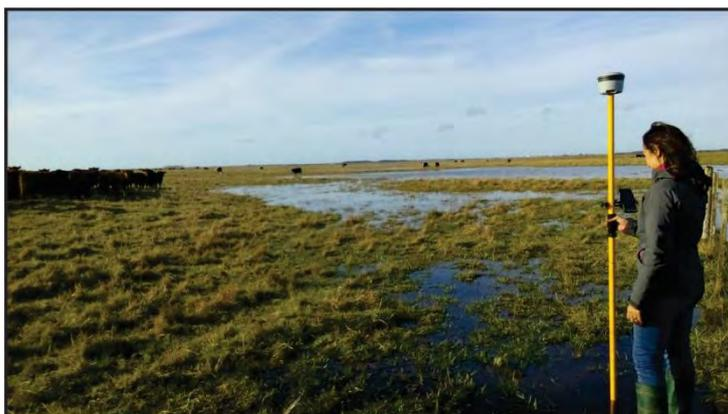
**Figura 2.5.** Foto tomada en campo durante la nivelación a boca de pozo con GPS diferencial.
